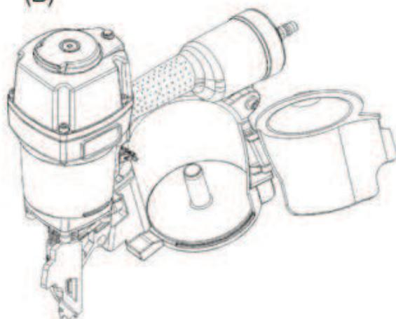
Beim **System für Coil-Nagler** (B) wird der Haken gedrückt und die Klappe geöffnet.
