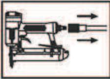
**Gefahr!** Das Eintreibgerät kann beim Transport unbeabsichtigt ausgelöst werden.
