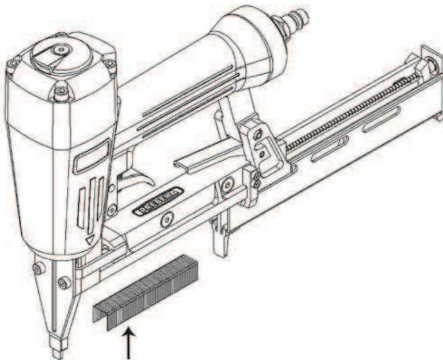
Beim **Oberlader-System** wird je nach Bauart entweder das Magazin-Oberteil nach dem Entriegeln, oder der Eintreibgegenstand-Vorschieber – bis zum Einrasten, zurückgezogen.
