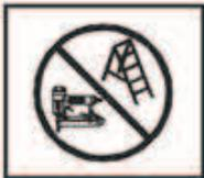
Eintreibgeräte, die mit Kontaktauslösung oder Dauerauslösung mit Auslösesicherung ausgerüstet und mit dem Symbol "Nicht von Gerüsten oder Leitern benutzen" gekennzeichnet sind, dürfen für oben genannte Anwendungen nicht benutzt werden.
