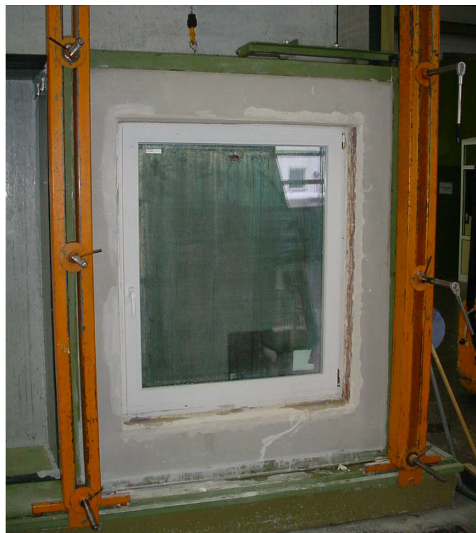
Bild 6 Probekörper auf dem Fensterprüfstand. Raumseitige Leibungen freigelegt zur Prüfung der Schlagregendichtheit nach simulierten Kurzzeitbelastungen.
