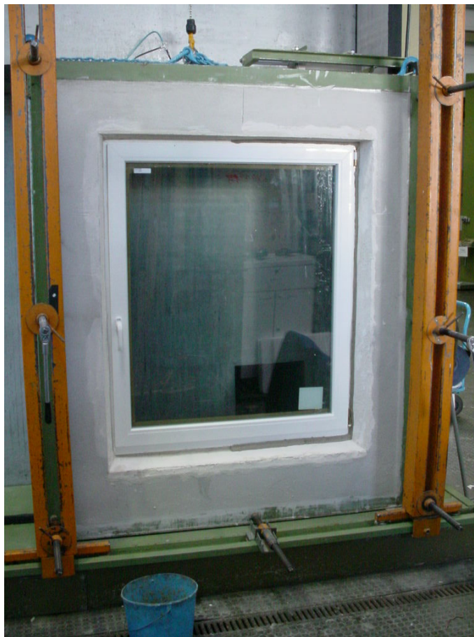
Bild 1 Probekörper auf dem Fensterprüfstand aufgebaut
