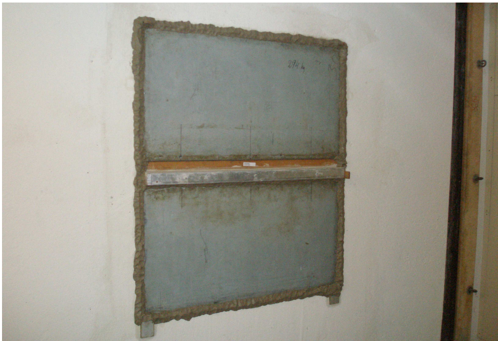
Bild 3 Foto der Fugenprüfstandsordnung, erstellt vom ift Labor Bauakustik
