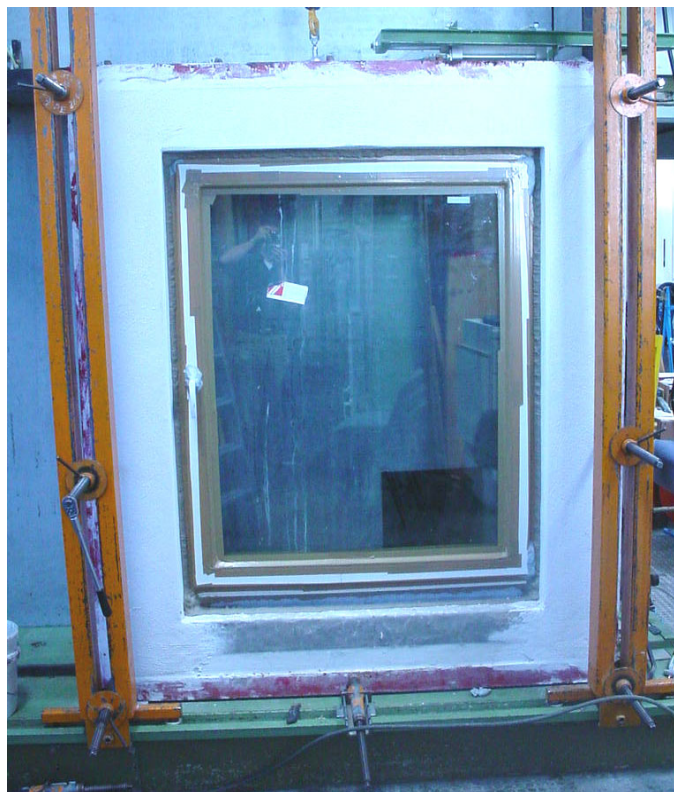
Bild 1 Probekörper auf dem Fensterprüfstand aufgebaut
