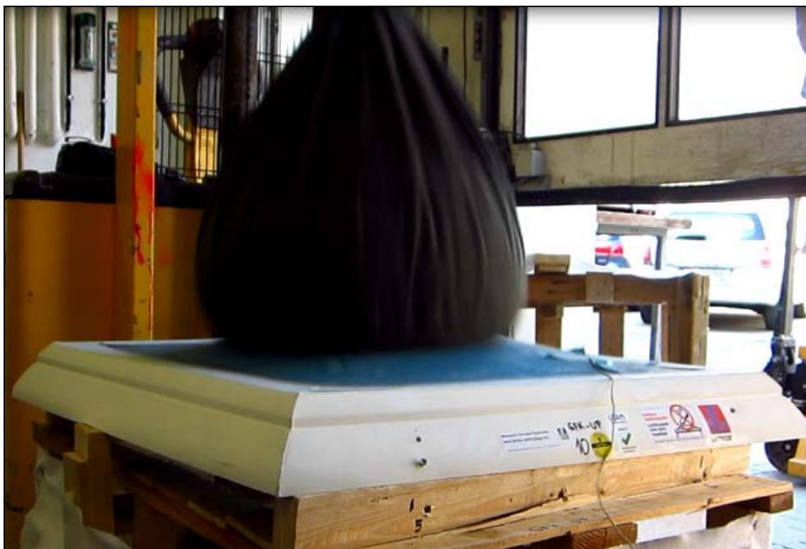
Abb. 6: Probekörper Nr. 10; bei Aufprall Stoßkörper
