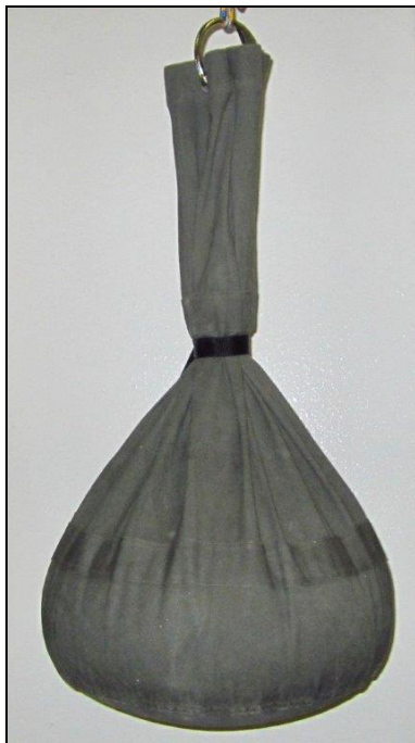
Abb. 2: Stoßkörper, Glasperlensack 50 kg
