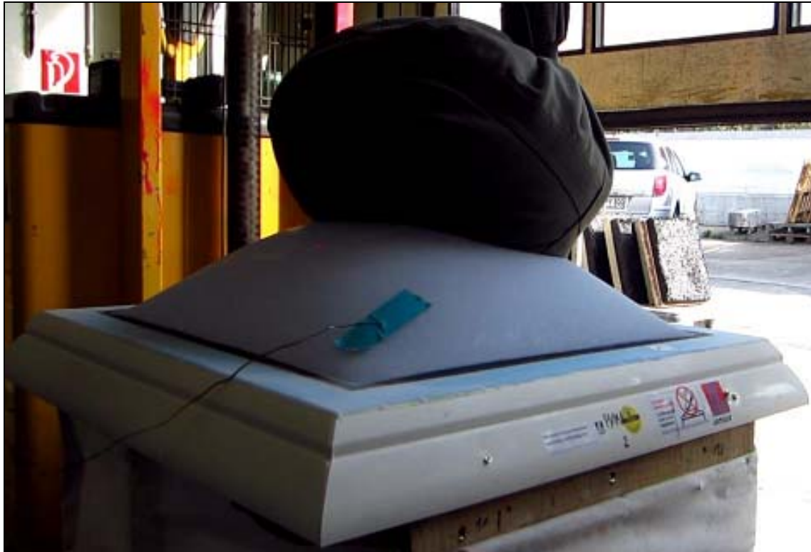
Abb. 3: Probekörper Nr. 2; nach Prüfung mit aufliegendem Stoßkörper
