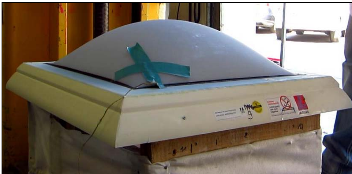
Abb. 4: Probekörper Nr. 9; nach Prüfung und Belastung mit Stroßkörper
