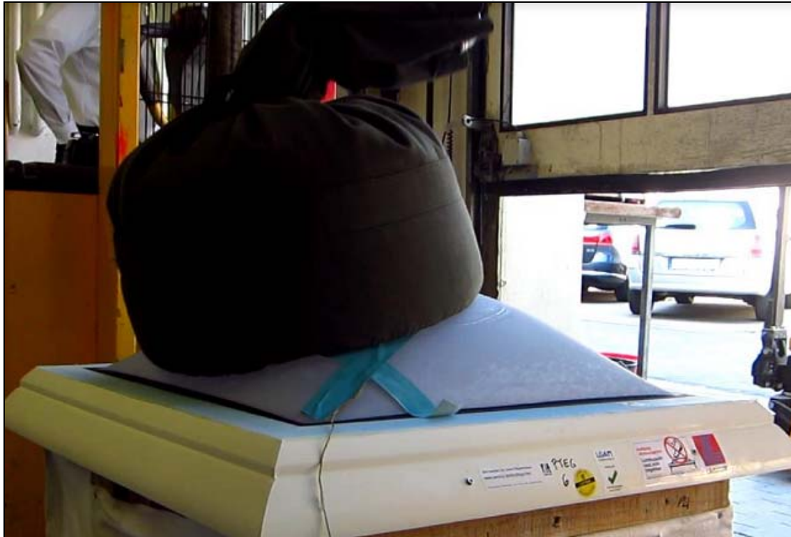
Abb. 7: Probekörper Nr. 6; nach Prüfung mit aufliegendem Stoßkörper
