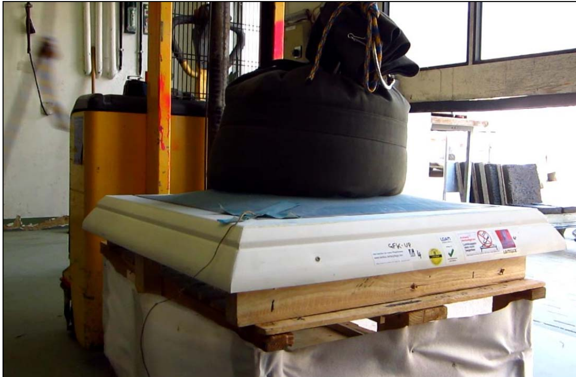
Abb. 5: Probekörper Nr. 4; nach Prüfung mit aufliegendem Stoßkörper
