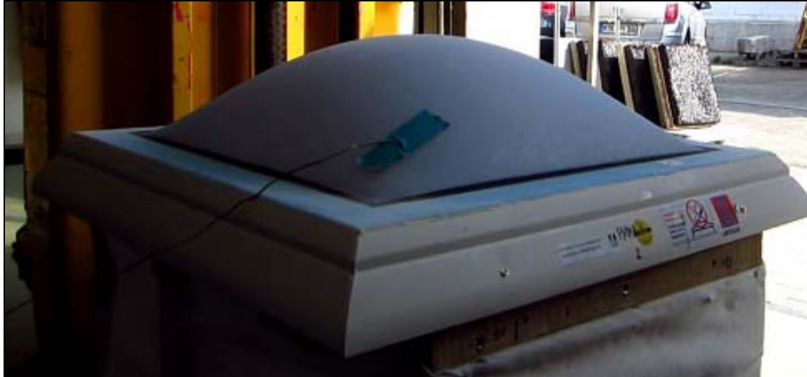
Abb. 1: Probekörper Nr. 2, vor der Prüfung
