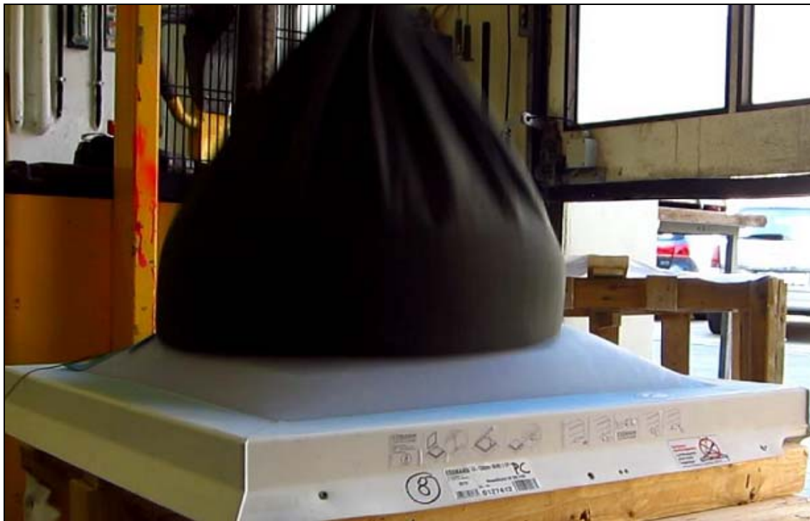
Abb. 10: Probekörper Nr. 8; erste Prüfung, bei Aufprall Stoßkörper
