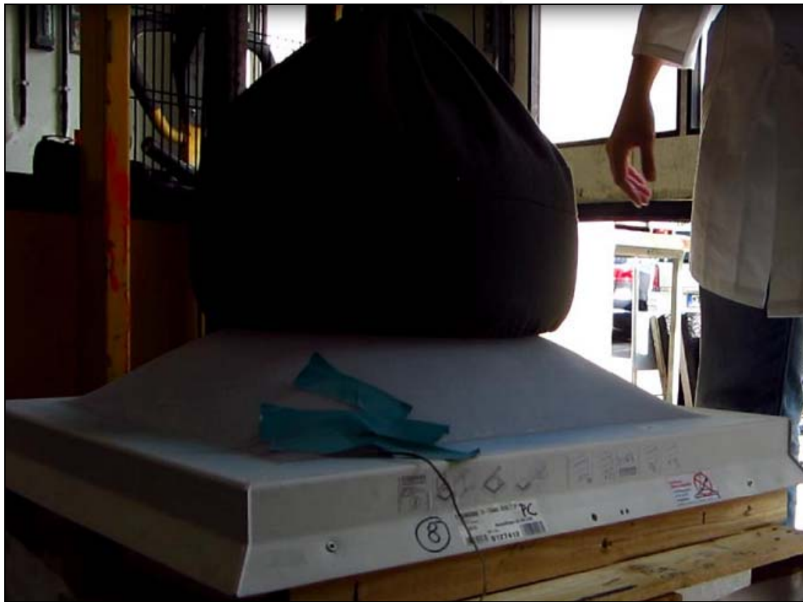
Abb. 11: Probekörper Nr. 8; zweite Prüfung mit aufliegendem Stoßkörper
