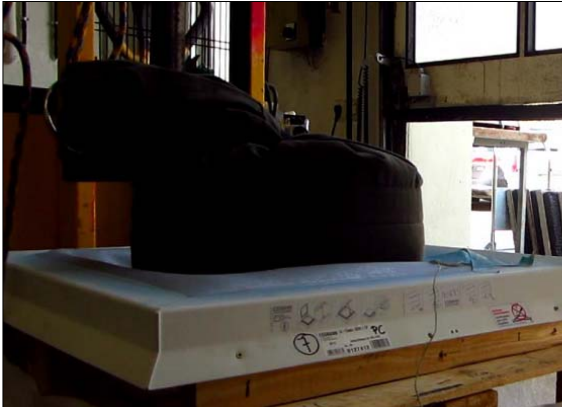
Abb. 9: Probekörper Nr. 7; nach Prüfung mit aufliegendem Stoßkörper
