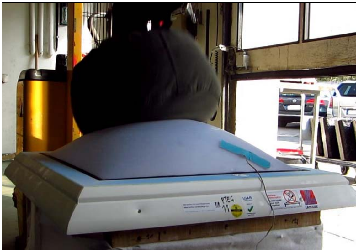
Abb. 8: Probekörper Nr. 11; nach Prüfung mit aufliegendem Stoßkörper
