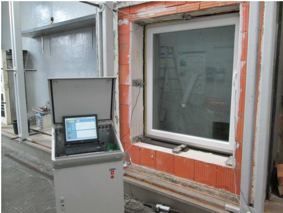
Bild 11 Ansicht Probekörper mit angebrachten Messstellen
