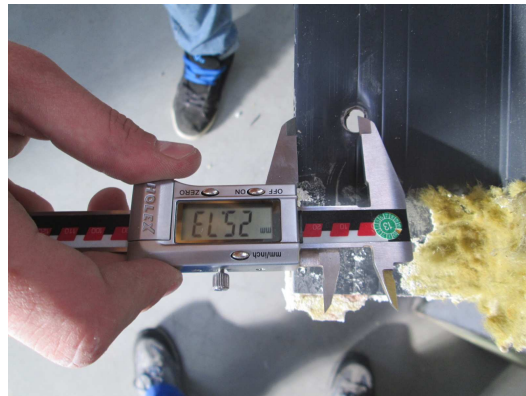
Bilder 21 und 22 Zustand der Bohrungen im Mauerwerk und im Montagewinkel nach Ausbau des Fensters.
