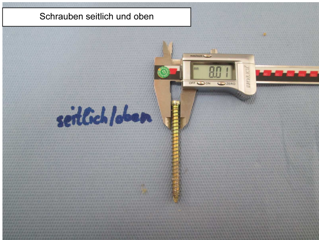
Bild 24 Zustand der Rahmenschrauben ohne Verformungen (Befestigung zwischen Montagewinkel und Blendrahmen, seitlich und oben)
