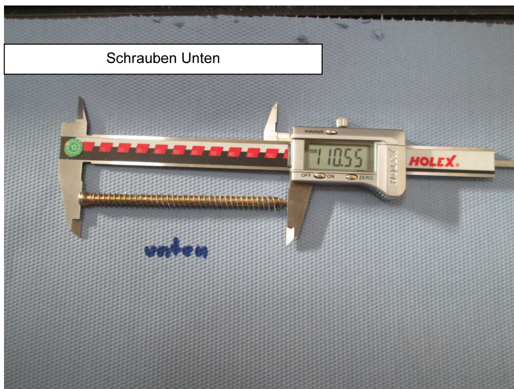
Bild 23 Zustand der Rahmenschrauben ohne Verformungen (Befestigung zwischen Montagewinkel und Blendrahmen, unten)
