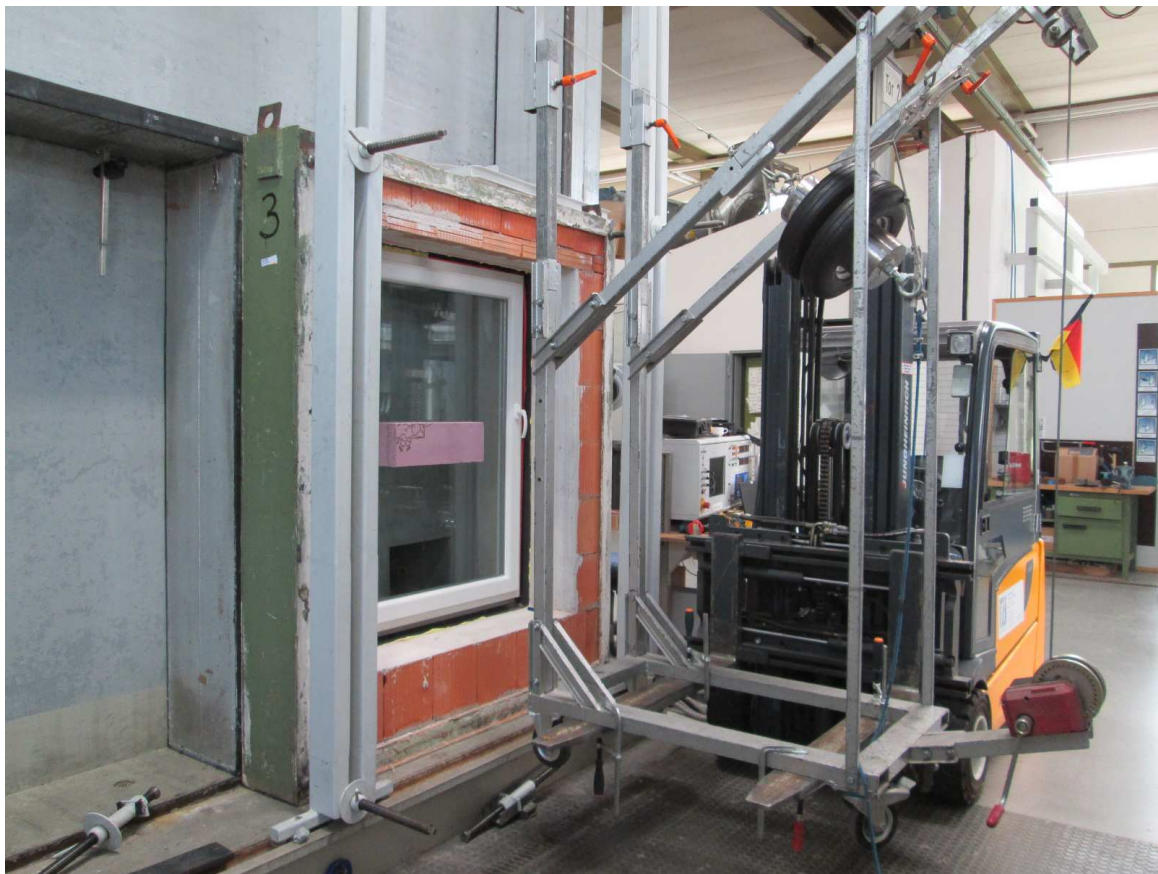
Bild 20 Prüfaufbau Pendelschlag
